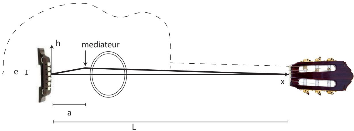
Ceci simule l'effet d'un médiateur ou d'un doigt qui déforme la corde et la relâche.
