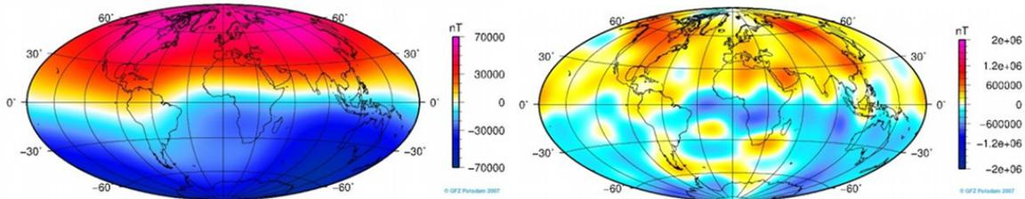
A gauche on voit l'intensité du champ magnétique radial  $B_r$  à la surface de la terre en  $r = R_{terre} = 6370 \text{ km}$ . A droite celle qu'on a à l'interface noyau-manteau, pour  $r = R_{noyau} = 3480 \text{ km}$  (source : GFZ Potsdam). Dans cet exercice, on cherche à comprendre pourquoi le champ en surface semble beaucoup moins finement structuré que celui sur l'interface noyau-manteau, comme le montre les figures.
