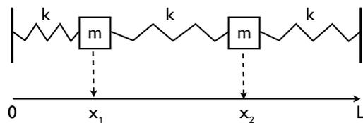
Deux masses identiques  $m$  sont tenues par trois ressorts à la constante de raideur  $k$  entre deux parois placées en  $x = 0$  et  $x = L$ . Les positions des deux masses sont suivies par les variables  $x_1(t)$  et  $x_2(t)$  qui peuvent varier au cours du temps  $t$ . Un peu de mécanique élémentaire (PFD) nous permet de trouver les deux équations du mouvement :
