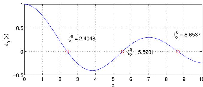
La fonction de Bessel  $J_0(x)$  a sa  $n$ -ième racine dans le point  $x = \zeta_n^0$ . Donner la fréquence d'oscillation  $f_n = \omega_n/(2\pi)$  de la  $n$ -ième onde stationnaire.
