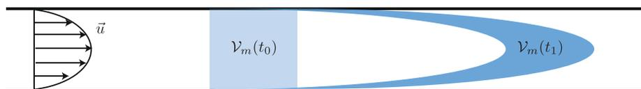
(d) Volume matériel dans un écoulement parabolique
