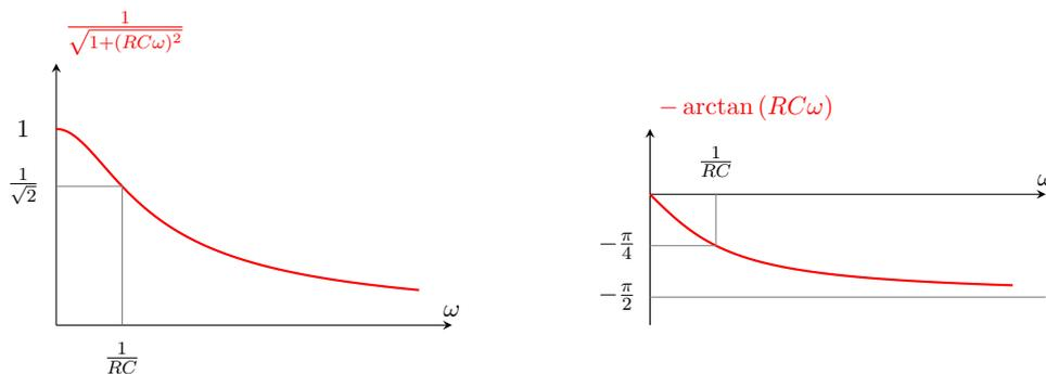
FIGURE 2 – Allure de l'évolution du module et de la phase de la réponse en fréquence d'un filtre RC série en fonction de la pulsation
