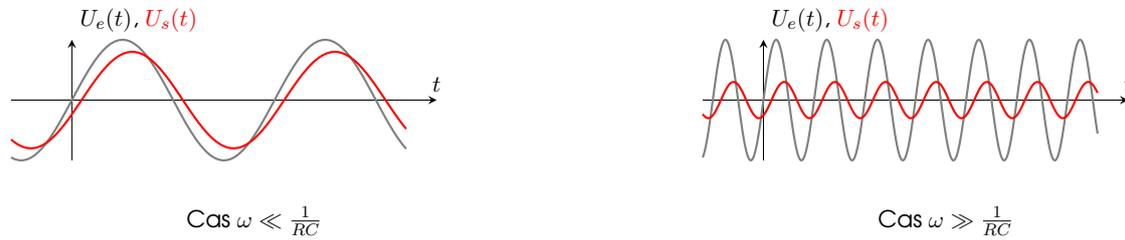
FIGURE 3 – Allure de l'évolution de la tension de sortie, selon la fréquence du signal sinusoïdal d'entrée.
