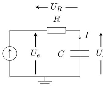
FIGURE 3 – Circuit étudié. La tension d'entrée est celle aux bornes du générateur, notée  $U_E$ . La tension de sortie est notée  $U_s$ .
